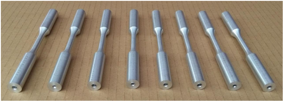
Slika 4. Epruvete za ispitivanje zamornih karakteristika na sobnoj temperaturi - izgled prije ispitivanja
