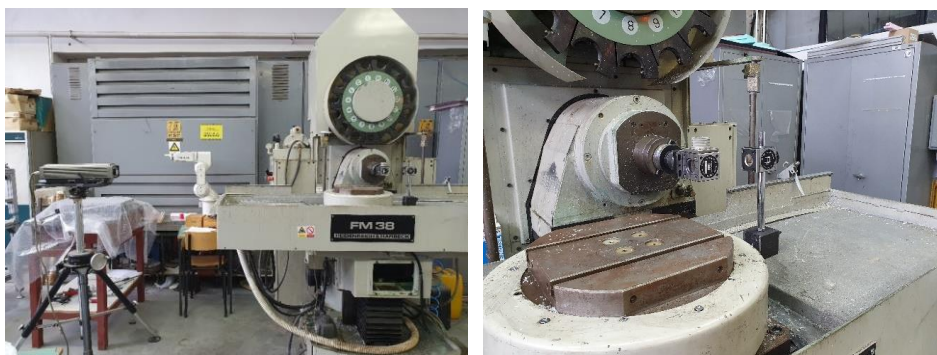
Slika 9. Prikaz postavljanja merne opreme pri ispitivanju tačnosti pozicioniranja ose "X" troosnog NU obrdnog centra
