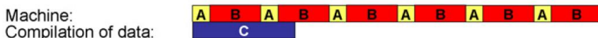
Slika 7. Poređenje metoda mapiranja grešaka za 3-osnu mašinu: (A) faza podešavanja, (B) faza prikupljanja podataka i (C) faza evaluacije
