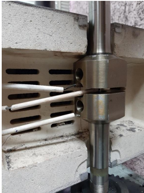
Slika 6. Postavljanje epruvete u komoru za zagrijavanje
