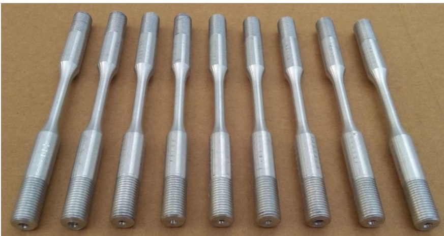
Slika 7. Epruvete za ispitivanje zamornih karakteristika na povišenoj temperaturi - izgled prije ispitivanja
