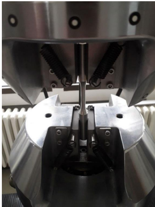
Slika 3. Postupak ispitivanja zamornih karakteristika materijala na sobnoj ( 23 \pm 5^\circ\text{C} ) temperaturi
