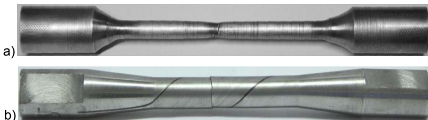
Sl.6 Deformisane epruvete: a) jednoosno zatezanje, b) uvijanje
