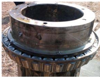
Sl. 5 Izgled konusno valjkastog ležaja sa zaostalim opiljcima i nečistoćama
