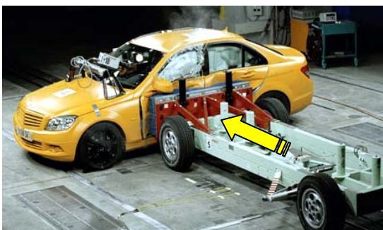
Sl. 3 Simulacija bočog udar test kolicima
