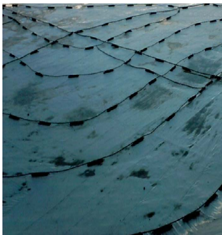
Sl.2 Cijevi za ispuštanje mjehurića [1]
