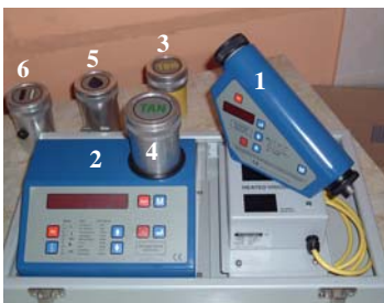
Sl. 2 Elektronski uređaj za merenje fizičko hemijskih karakteristika ulja - KITTIWAKE
